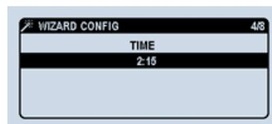
Ces valeurs date/heure sont sauvegardées et, à partir de ce moment, la batterie RTC maintient l'horloge en fonction, même en cas de perte de l'alimentation du contrôleur.
