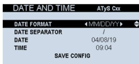
La date et l'heure continuent de fonctionner grâce à la batterie RTC, même en cas de coupure de toutes les sources. Ce menu permet toutefois de modifier la date et le format de date.
